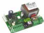
Плата управління 540 BPR (вмонтована в привід)
