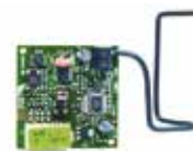
Приймач MONOCANALE 433 RC (для пультів GENIUS ECHO)
