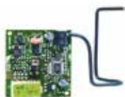
Двоканальний приймач 433 RC (для пультів GENIUS ECHO)
