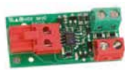
Плата BUS XIB для сполучення релейних фотоелементів (для плати управління E045S або E024S)
