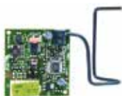
Приймач MONOCANALE 433 JLC (для пультів GENIUS KILO)
